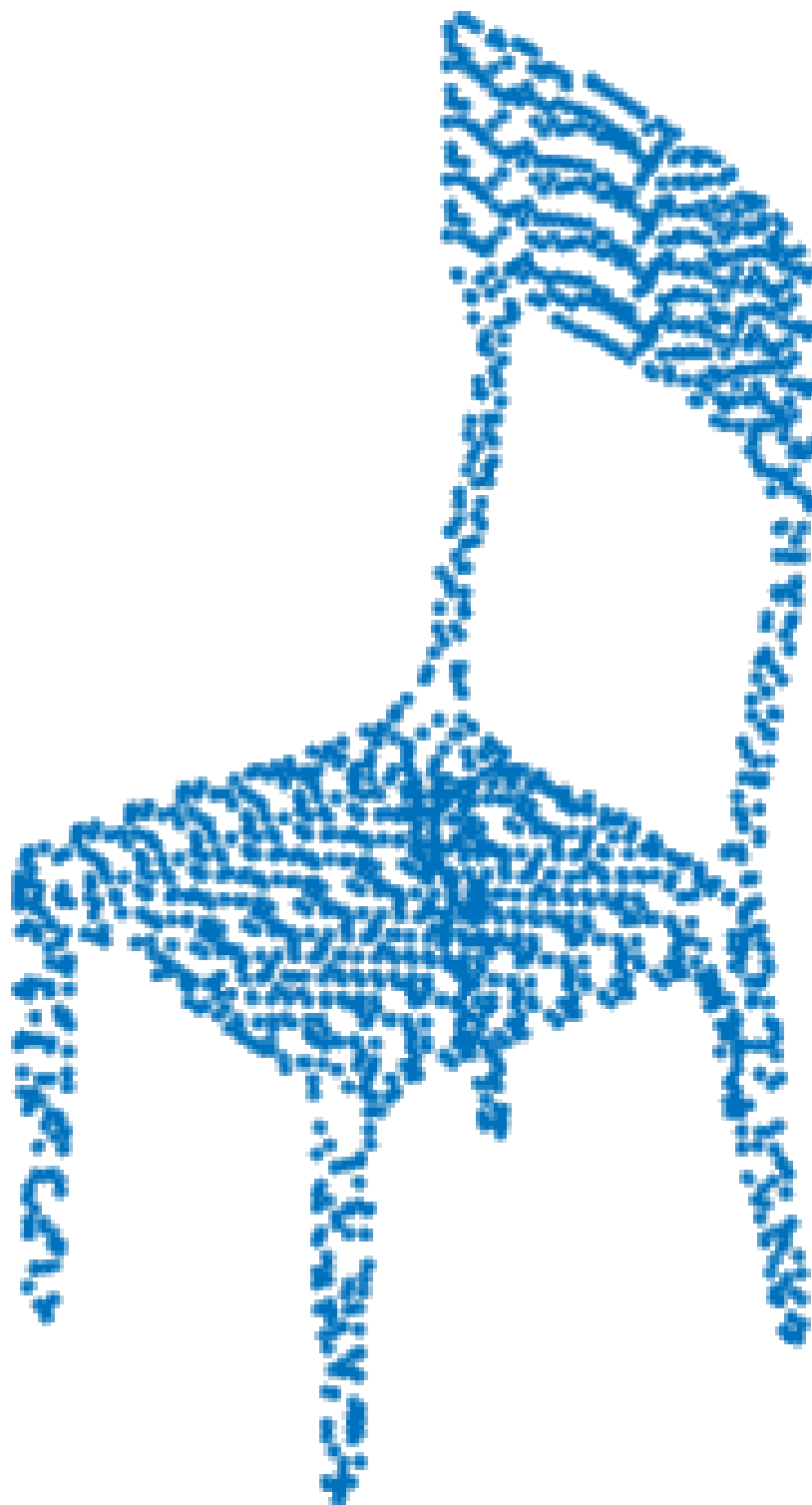
Figura 3 – Representação de uma forma 3D como nuvem de pontos.
